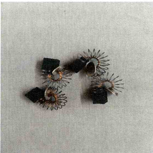
Figura NO.15 Cambio de brush motor
