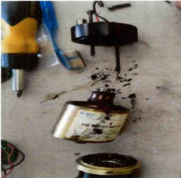
Figura NO.13 mantenimiento transportador pipe ranger
