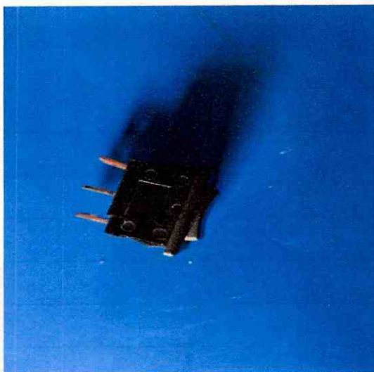
Figura NO.7 Switch de 3 posiciones
