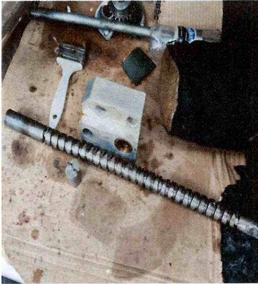
Figura NO.5 Desmontaje Tornillo Sin fin
