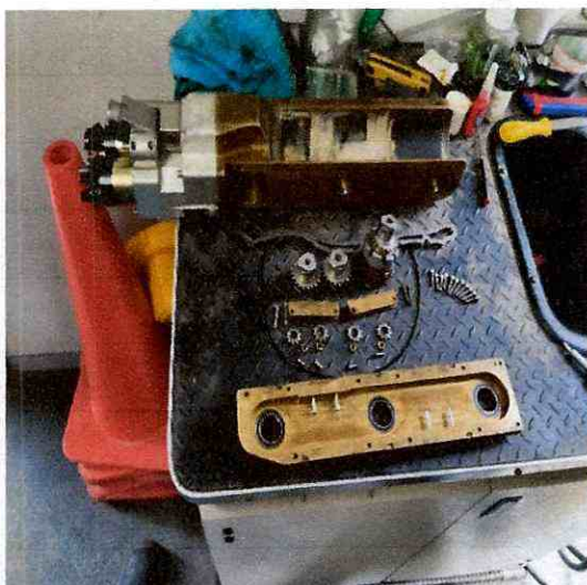
Figura NO.7 cambio sello, rodamiento, oring
