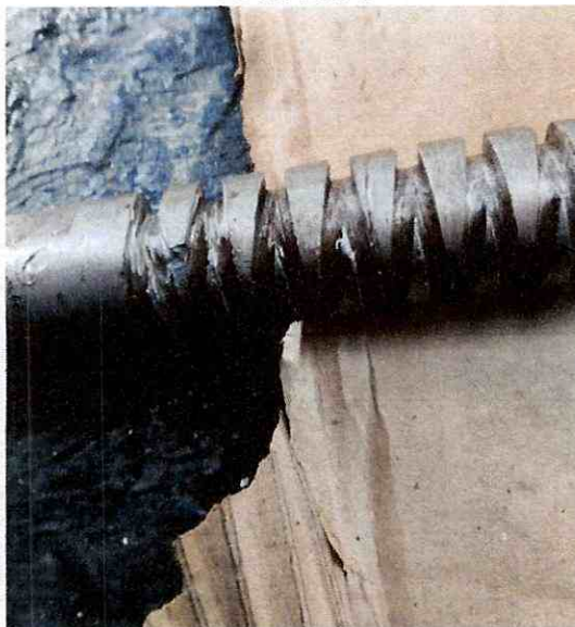
Figura NO.3 Tornillo Sin fin con pérdida de material
