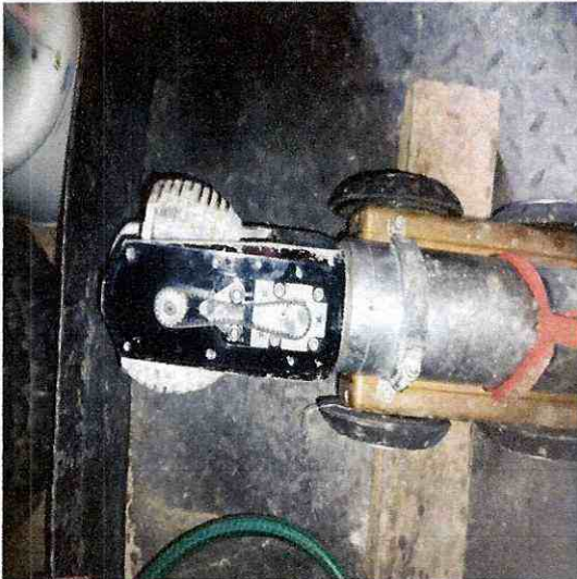
Figura NO.29 revision cámara oz II y Instalación belt timing
