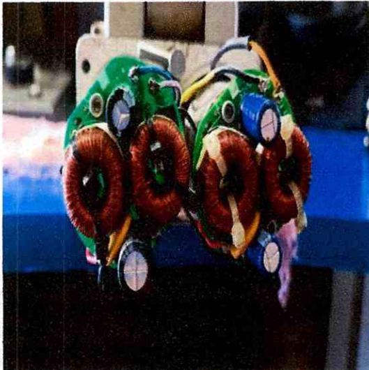
Figura NO.17 Reparación de tarjeta filtros
