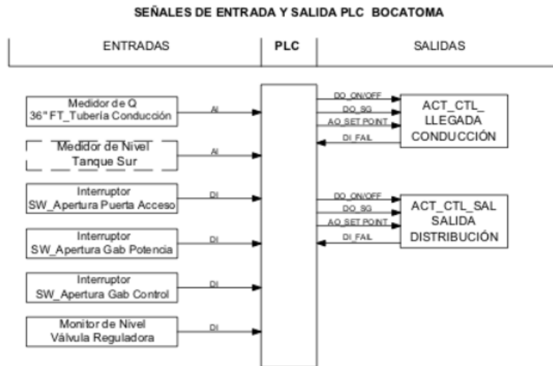
Imagen 12. Señales de Entrada y Salida Tanque Sur
