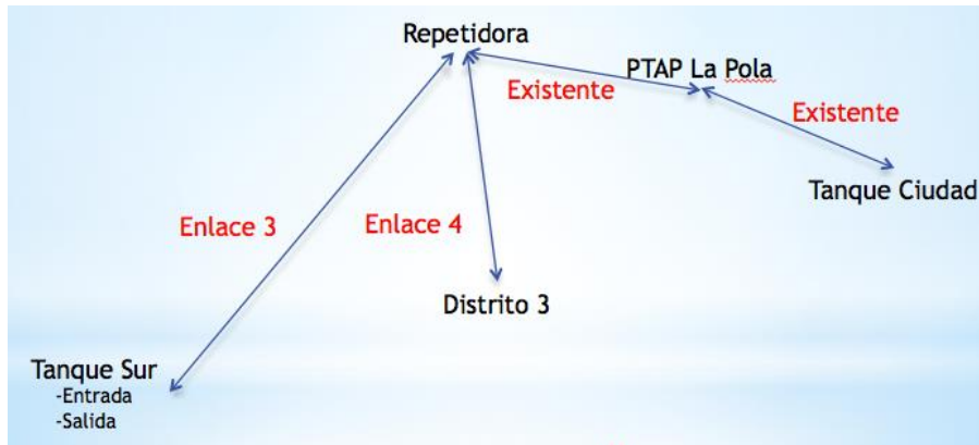
Imagen 25. Esquema de Comunicaciones Conducción - Distribución
