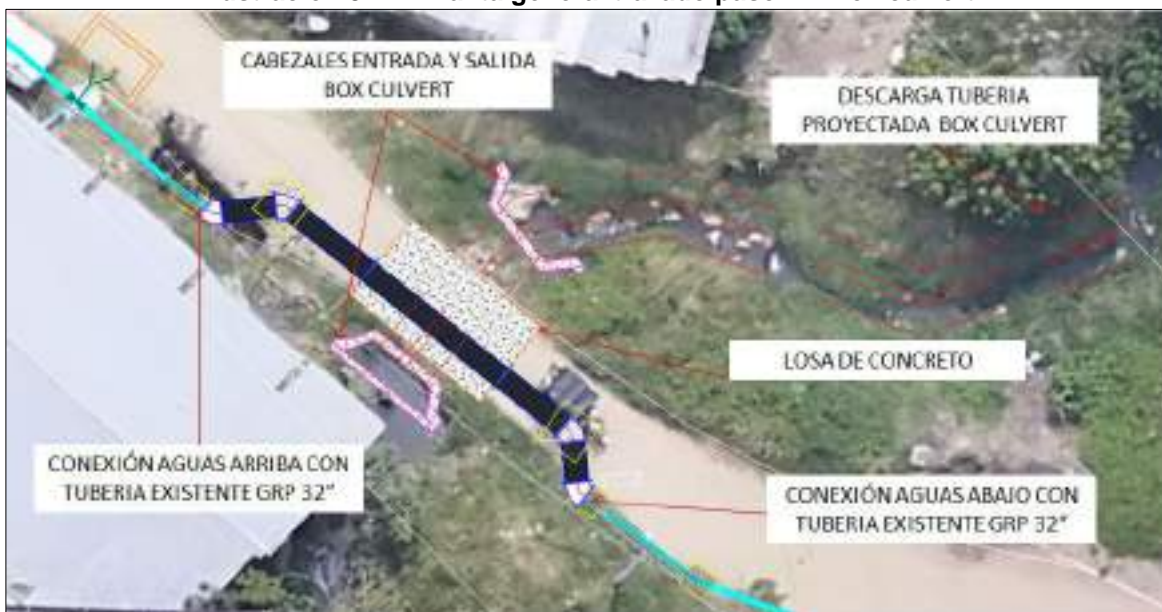
Ilustración 8-122 Planta general trazado paso 1 – Box culvert
