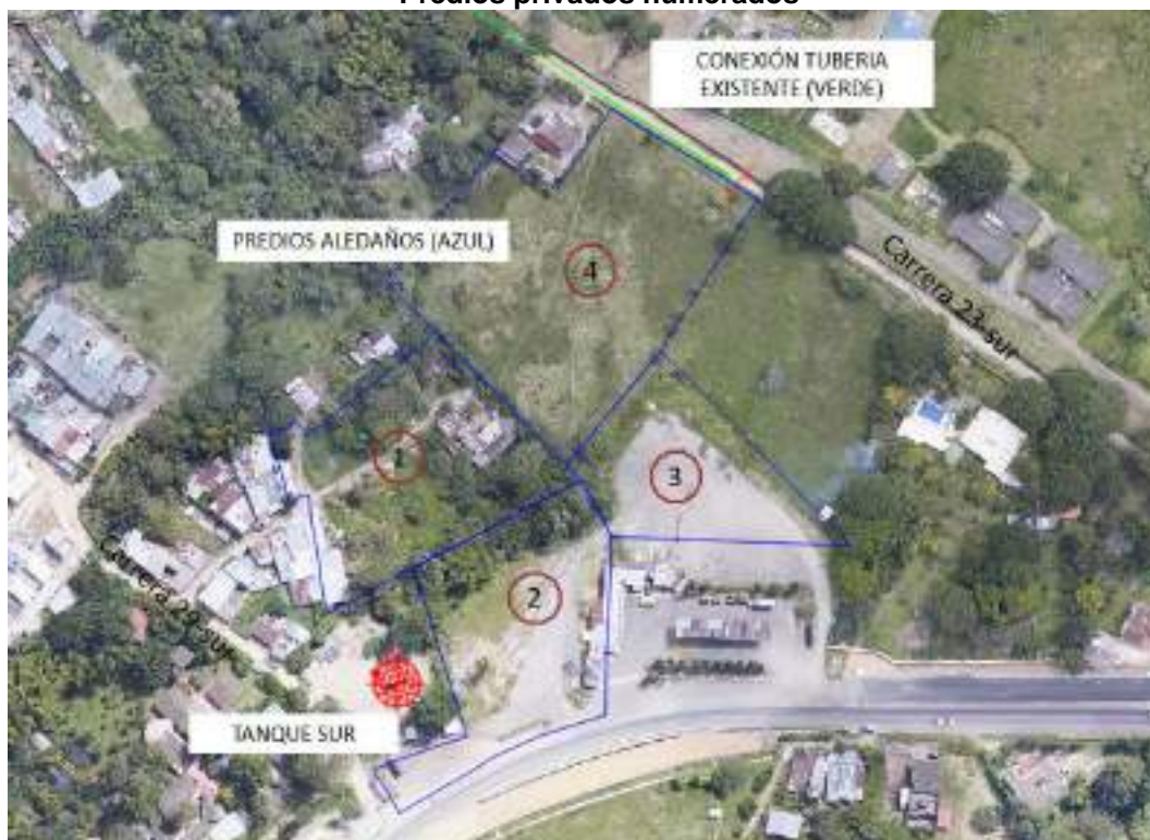
Ilustración 8-139 Planta general sector de salida tanque sur y conexión con tubería existente – Predios privados numerados
