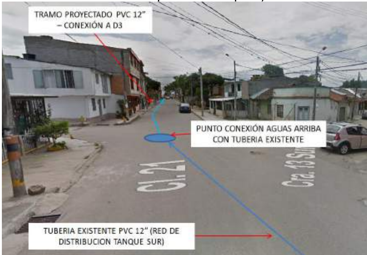
Ilustración 8-145 Punto de conexión aguas arriba con tubería existente de PVC 12" (Red de distribución proveniente de tanque sur)
