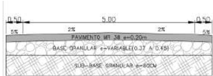
Ilustración 8-66 Pavimento – Sección vía
