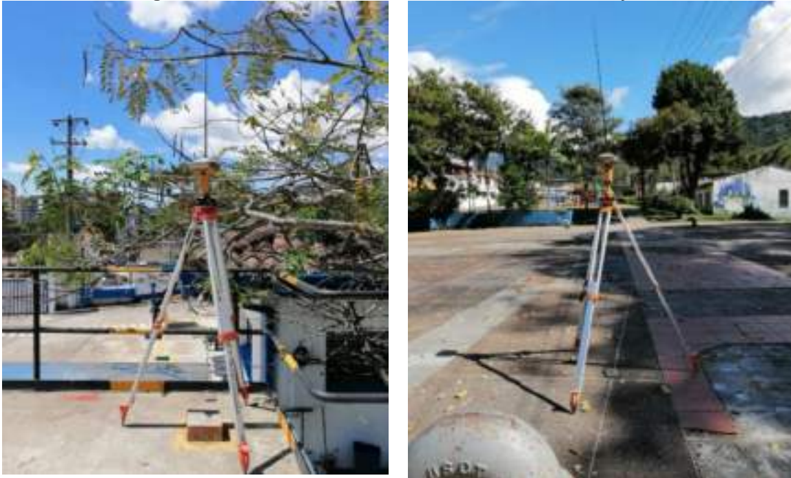
Fotografía 8-3 Posicionamiento Placa IBAL -066-GPS-001 y P-415
