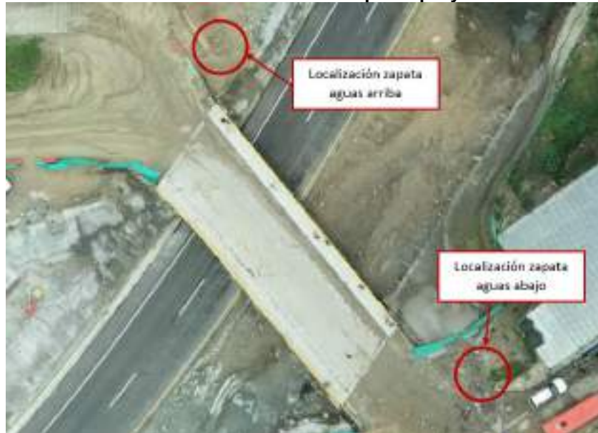
Ilustración 8-79 Localización zapatas proyectadas
