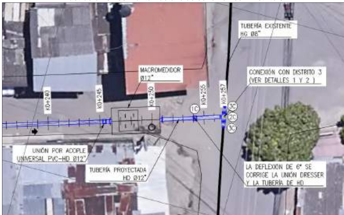
Ilustración 8-156 Planta - detalle de conexión con Distrito 3
