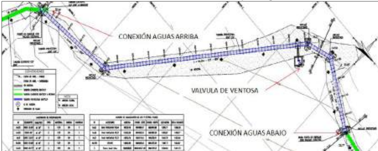
Ilustración 8-55 Alineamiento horizontal – planta general
