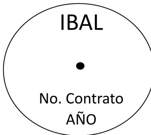
En caso que en cercanías de la obra no cuente con espacios como se requieren para la instalación de la incrustación, el ente ejecutor deberá hacer además un mojón en concreto de por lo menos las siguientes dimensiones: 0.3m x 0.3m x 1m dejando 0.2m por encima de la rasante para la placa.
