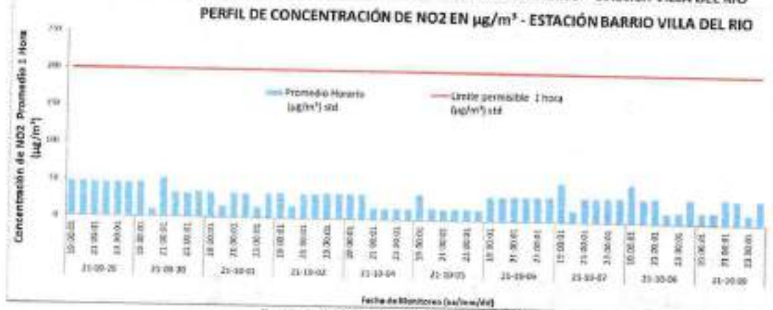
Gráfica 7.7 Comparación de los resultados horarios NO 2 con el límite normativo - Estación VILLA DEL RIO
