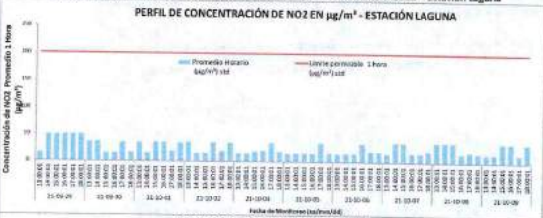
Gráfica 7.6 Comparación de los resultados horarios NO 2 con el límite normativo - Estación Laguna
