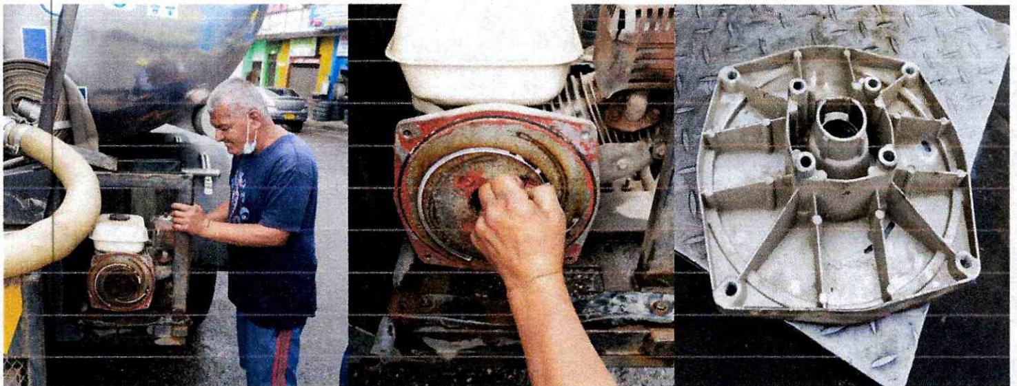
16,88 Cambio de carcasa motobomba de 4" carro tanque
