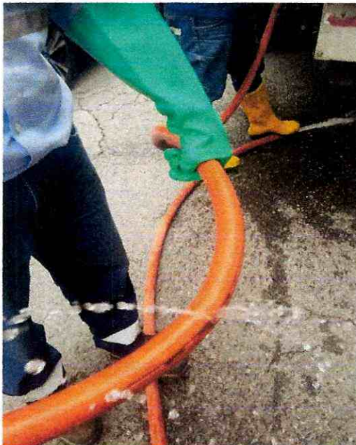
FIGURA 15. MANGUERA DE SONDEO RASGADA CON HUECOS
