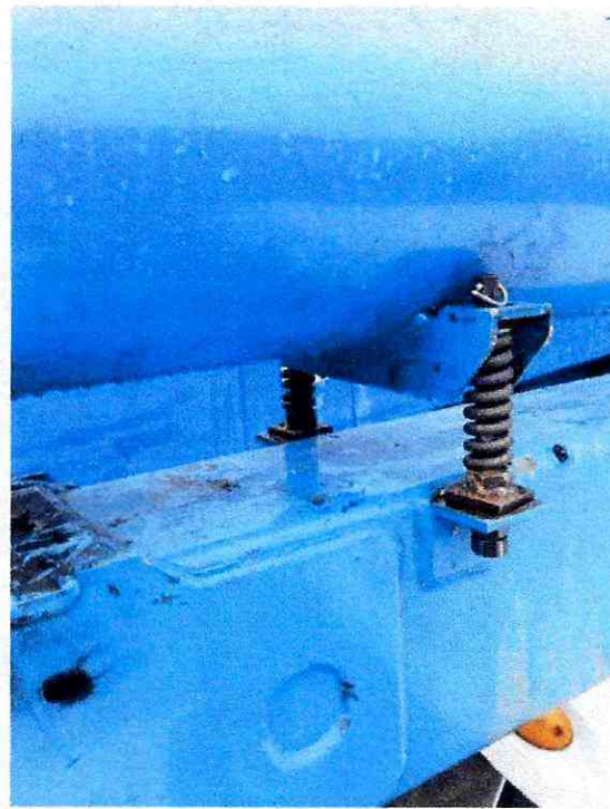
FIGURA 18. SUMINISTRO DE SPRING PARA AJUSTE DE TUBO DE SUCCION
