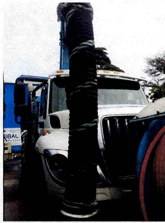
FIGURA 18. CAMBIO DE MANGUERA DE SUCCION CON FLANCHE INSTALADOS
