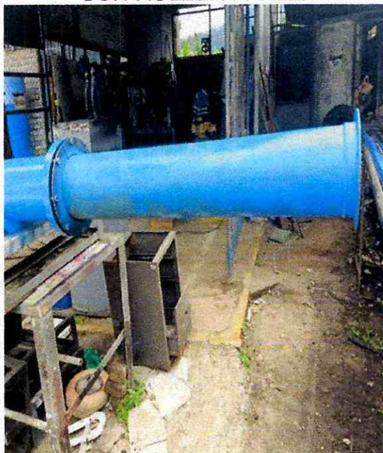
FIGURA 17. SUMINISTRO DE TUBO INTERNO DE SUCCION, TORNILLOS Y SELLOS
