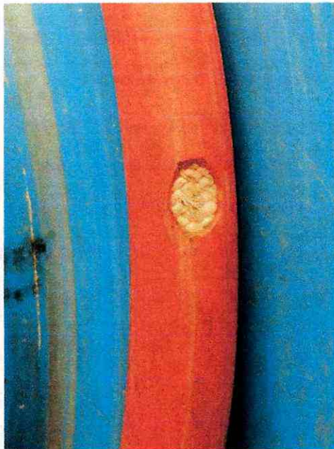
FIGURA 7. MANGUERA DE SONDEO CON PERDIDA DE MATERIAL
