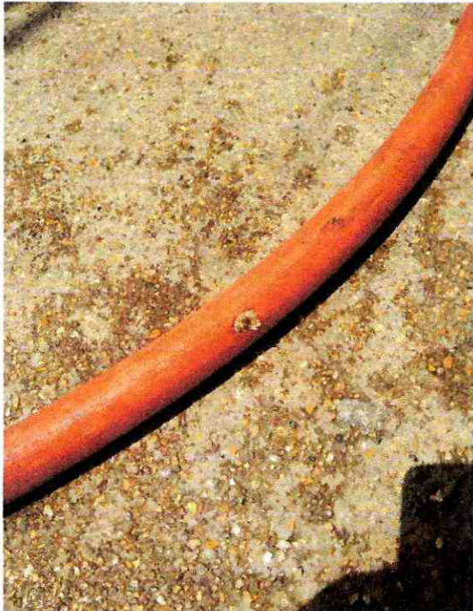
FIGURA 13. MANGUERA DE SONDEO RASGADA CON HUECOS
