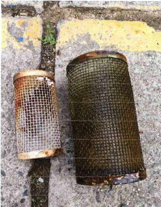
FIGURA 79. filtros contaminados, con perdida de material
