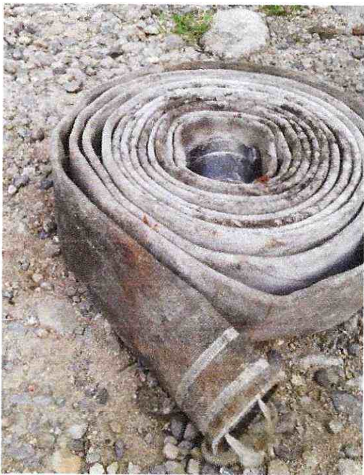
FIGURA 81 manguera de llenado de agua con deterioro generando fugas
