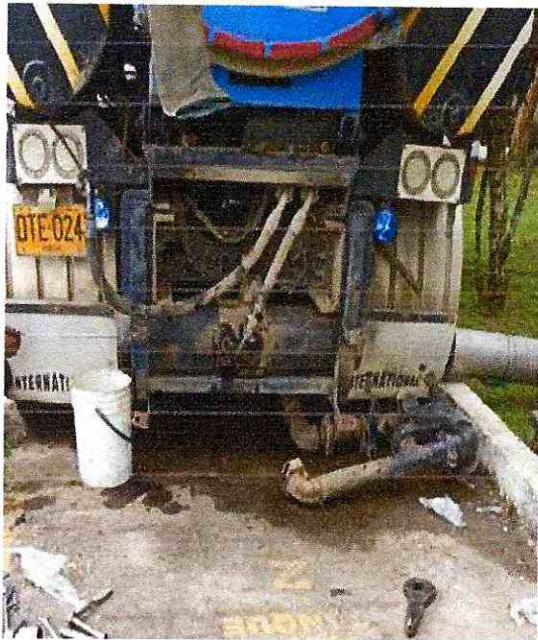
FIGURA 49. Revisión y desmontaje bomba de agua
