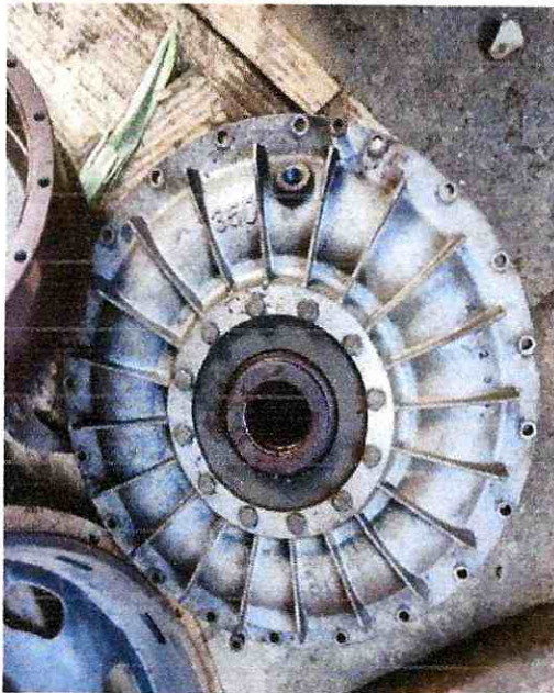
FIGURA 27. Desmontaje acople fluido
