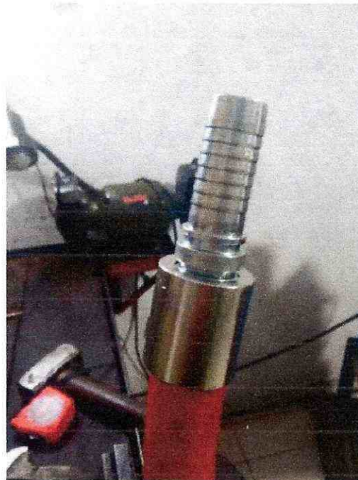
FIGURA 6. REPARACION MANGUERA DE SONDEO
