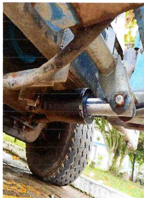
FIGURA 8. MONTAJE CILINDRO HIDRAULICO REPARADO LEVANTE CARRETEL
