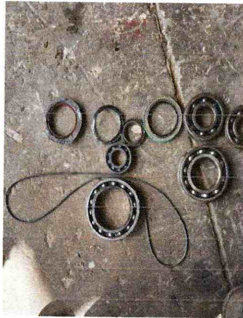
FIGURA 34. Rodamientos y sellos con deterioro interno
