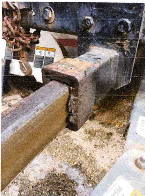
FIGURA 71. Desgaste interno en rodamiento lineal
