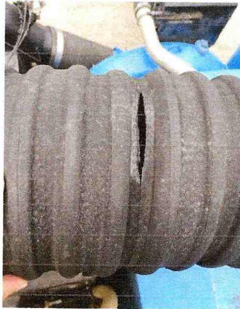
FIGURA 2. Manguera con deterioro y fatiga material con agujero
