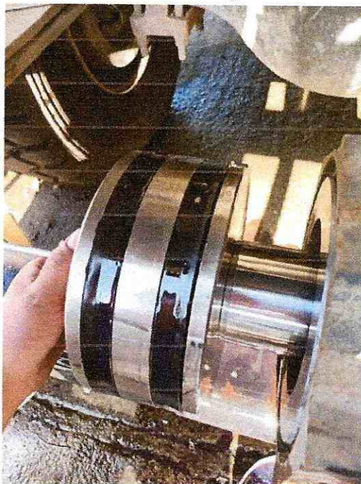
FIGURA 51. Revisión y desmontaje bomba de agua, pistón recostado con empaque picado
