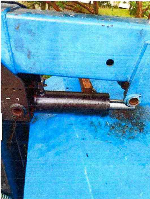
FIGURA 5. MONTAJE DE CILINDRO HIDRAULICO REPARADO LEVANTE BOOM
