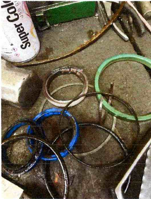
FIGURA 9. SELLOS Y EMPAQUES EN MAL ESTADO
