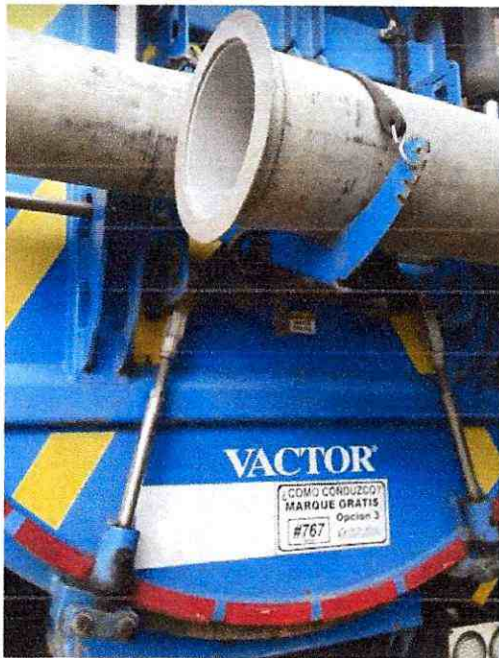
FIGURA 85 instalación de caucho de sujeción tubos vacío
