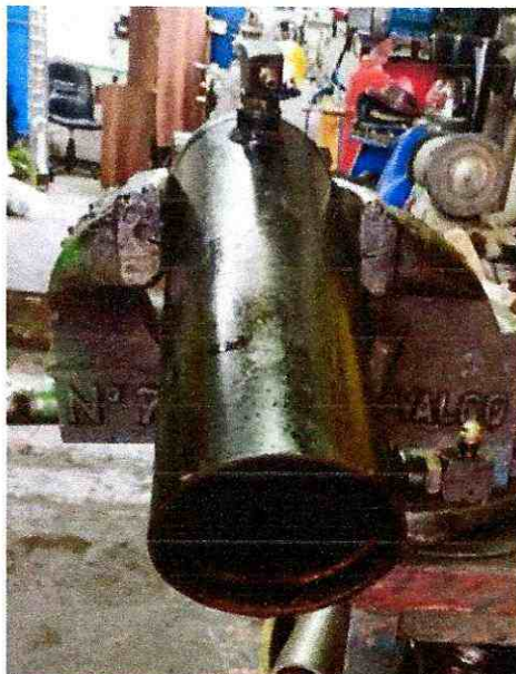
FIGURA 3. DESARME DE CILINDRO HIDRAULICO LEVANTE BOOM
