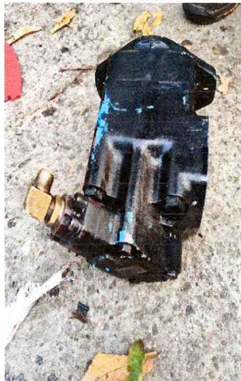
FIGURA 12. DESMONTAJE BOMBA HIDRAULICA CON FUGAS
