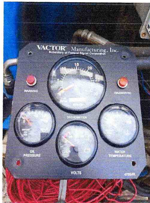
FIGURA 20. Instalación indicadores, presión aceite, temperatura y voltaje nuevos
