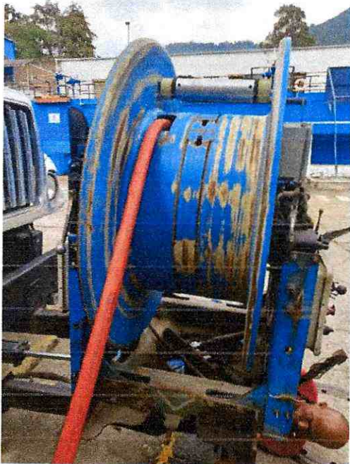
FIGURA 67. Desmonte carretel manguera de sondeo
