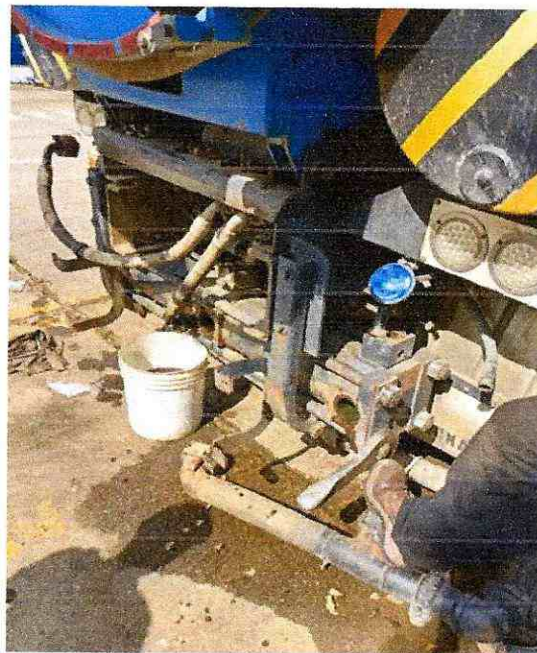
FIGURA 50. Revisión y desmontaje bomba de agua
