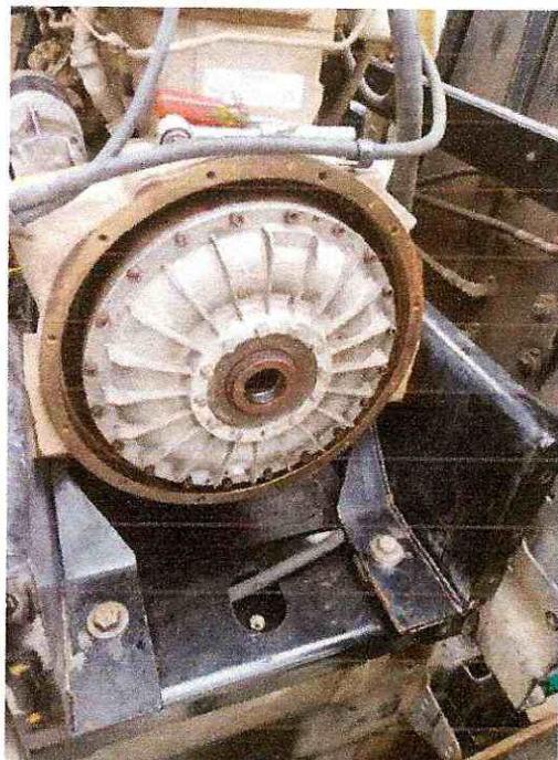
FIGURA 39. Montaje acope fluido
