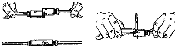
Figura 2 – Conexión y desconexión de varillas
