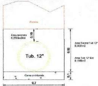
ATRAQUE TUBERÍA RED PRINCIPAL 12"
