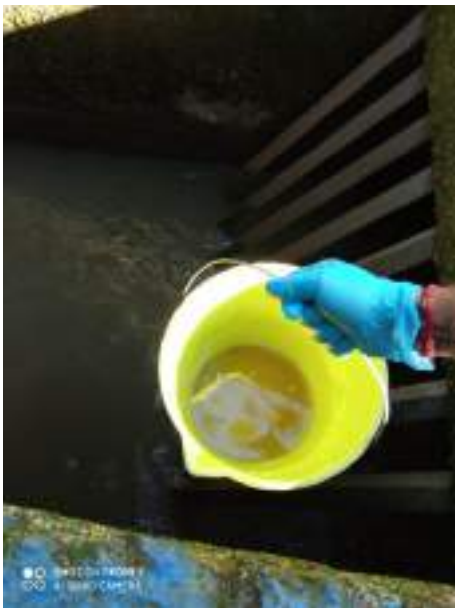
Fotografía 3 Toma muestras en entrada PTARD
