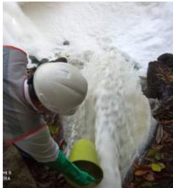
Fotografía 4 Toma de muestras en salida PTARD
