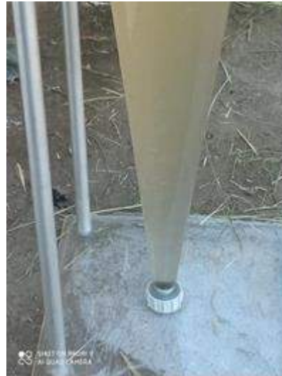
Fotografía 10 Lectura de sólidos sedimentables in Situ
