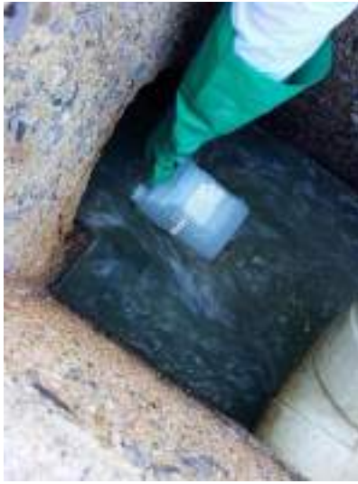
Fotografía 1 Toma de alícuota entrada a PTARD
