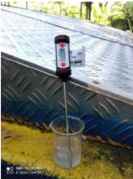
Fotografía 11 Medición de temperatura In situ
