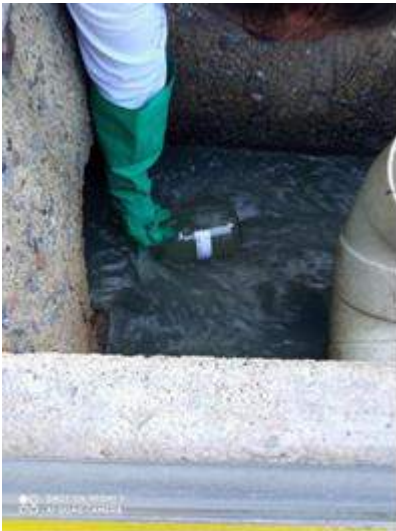
Fotografía 3 Toma directa para grasas y aceites en entrada PTARD
