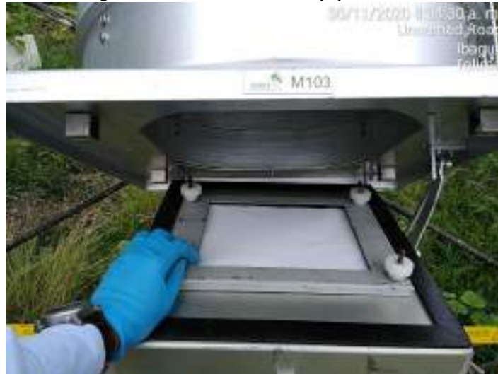
Fotografía 5.5 Filtro localizado en equipo HiVol PM10
