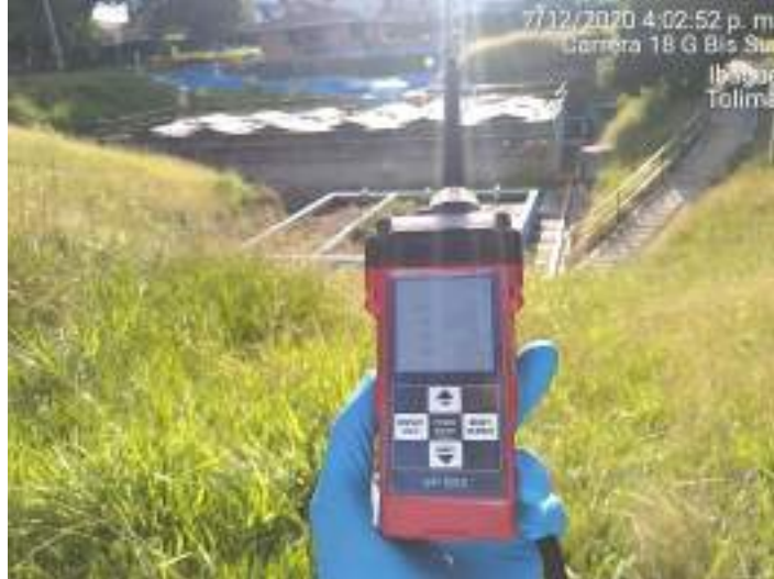
Fotografía 5.14 equipo de lectura directa para medición de H 2 S y CH 4
