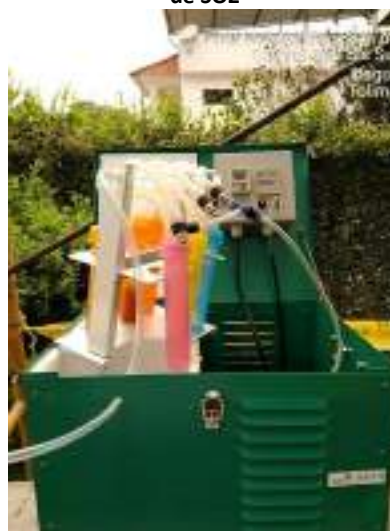
Fotografía 5.2 Equipo Rac de gases para monitoreo de SO2
