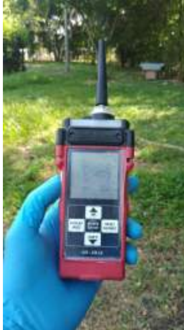
Fotografía 5.14 equipo de lectura directa para medición de H 2 S y CH 4
