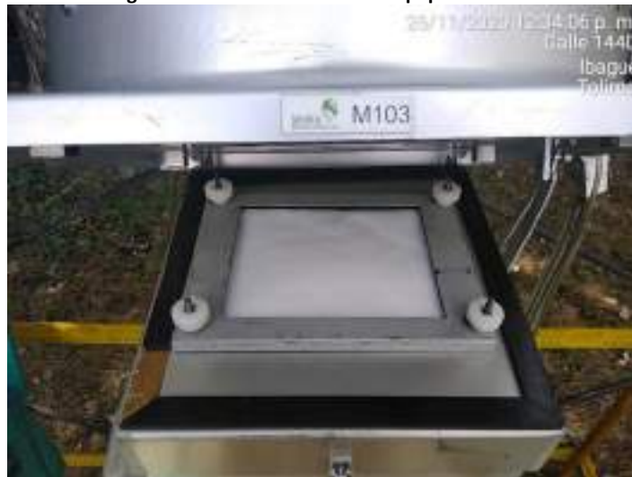
Fotografía 5.5 Filtro localizado en equipo HiVol PM10
