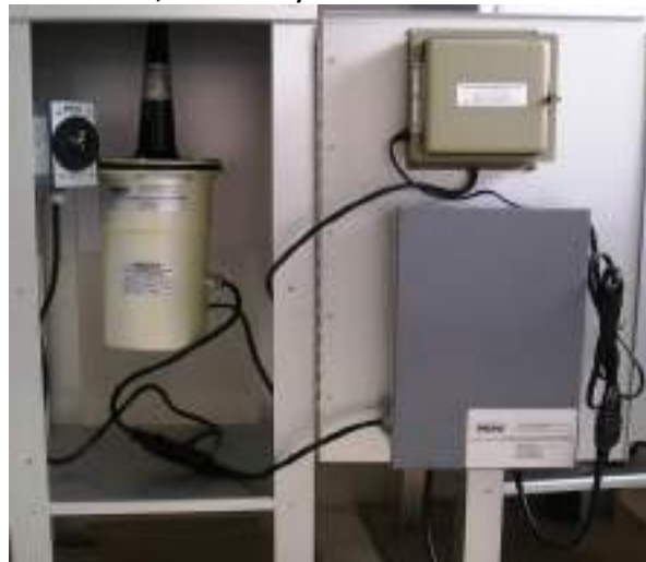
Fotografía 5.6 Motor, horómetro y timer mecánico de muestreador 6070V
