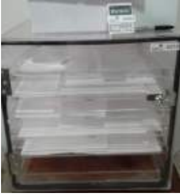
Fotografía 5.8 Acondicionamiento de filtros
