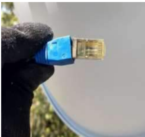
Antes del cambio de terminal RJ45
