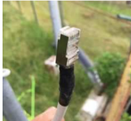
Estado de los terminales RJ45 en el cableado de datos
